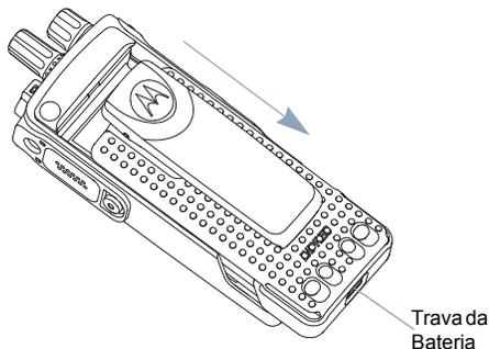
*Para remover a bateria, desligue o rádio. Mova a trava da bateria para a posição destravada, segure e deslize a bateria para baixo e para fora dos trilhos.*
