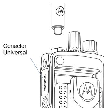
Insira a extremidade com gancho nas aberturas acima do conector universal. Pressione para baixo a tampa para ajustar a lingueta inferior corretamente no conector de RF.
