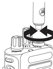
Com o rádio desligado, coloque a antena em seu receptáculo e gire em direção horária.
